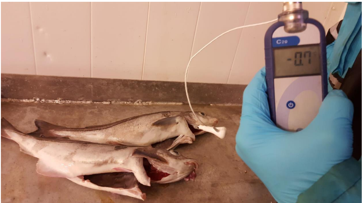
Figur 17: Rask nedkjøling og ubrutt kjølekjede er viktig for holdbarhet og kvalitet. Kontinuerlig temperatur under 0°C gir vesentlig lengre holdbarhet enn bare få grader høyere temperatur.
